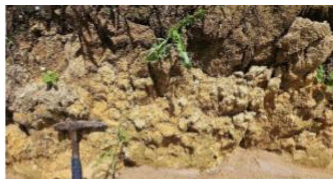
Perfil de solo com coloração amarelada em área mapeada como de ocorrência de cambissolo.
