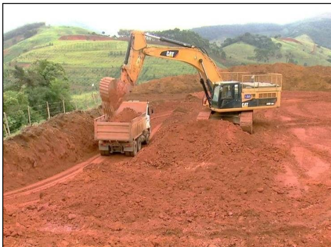
Figura 7. Operações de desmonte e transporte em lavra de extração de argila.
