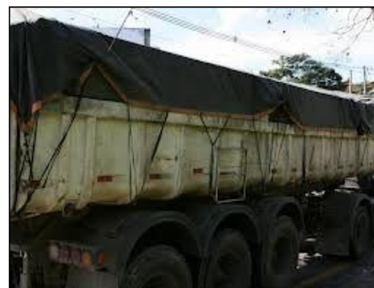
Figura 57. Uso de lona para cobertura da caçamba durante o transporte de material.
