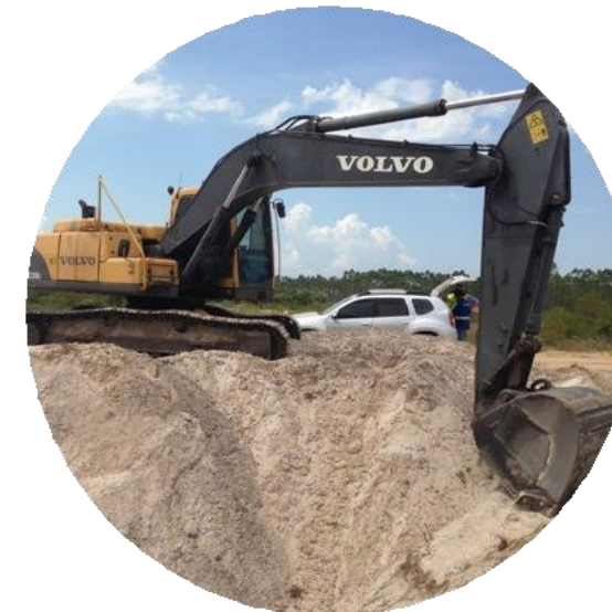
Desmonte mecânico da areia com escavadeira hidráulica para carregamento em caminhão basculante e transporte até as instalações de beneficiamento.
