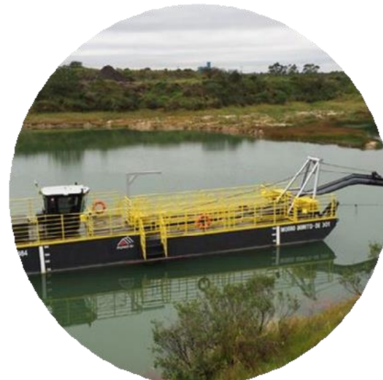
Draga flutuante utilizada para lavra de areia na mina Morro Bonito.
