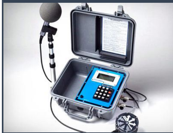
Modelo de sismógrafo de engenharia utilizado para registro de vibração e pressão acústica
