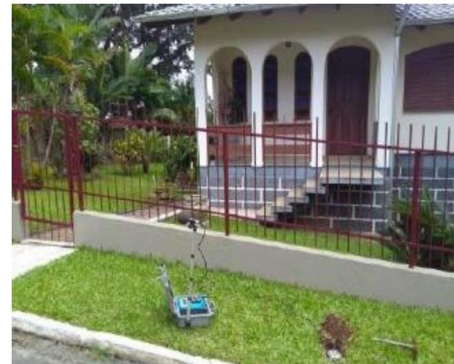
Conforme os valores atingidos de velocidade de pico de partícula (PPV) nos três eixos ortogonais, foi possível aferir que nenhum deles demonstrou-se acima do que a norma regulamentadora permite. O dado de maior valor de PPV foi obtido no monitoramento 7, que ocorreu no Engenho Turamix a 350 metros da
