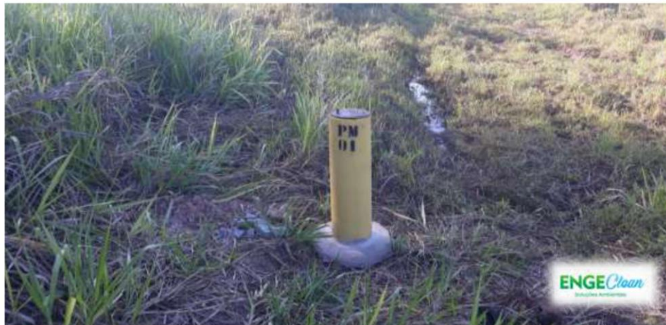
Figura 07: Poço de monitoramento PM 01
