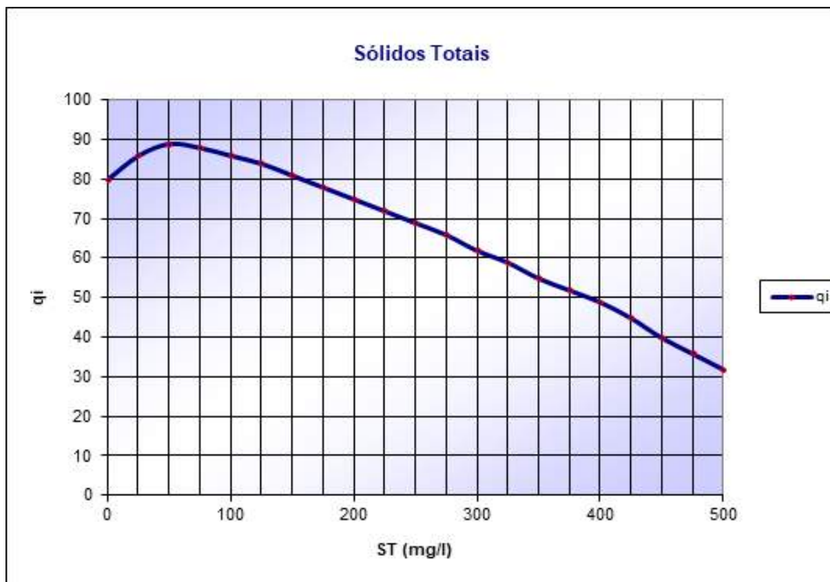
Figura 29 - Curva média de variação de qualidade de Sólidos Totais para o cálculo do IQA. O cálculo desse indicador se dá pelo produtório ponderado dos 9 parâmetros:
