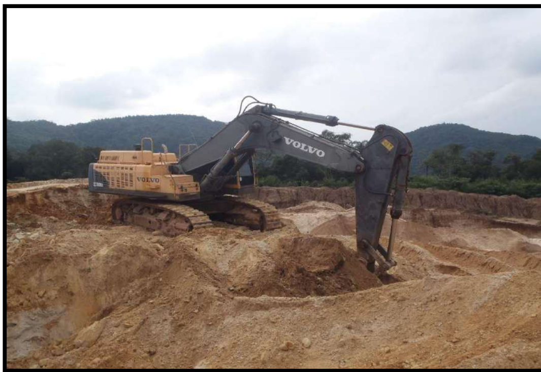
Figura 2- operação de desmonte do material utilizando-se escavadeira hidráulica na em frente de lavra na Jazida Seger. Fonte: Autor, 2016.
