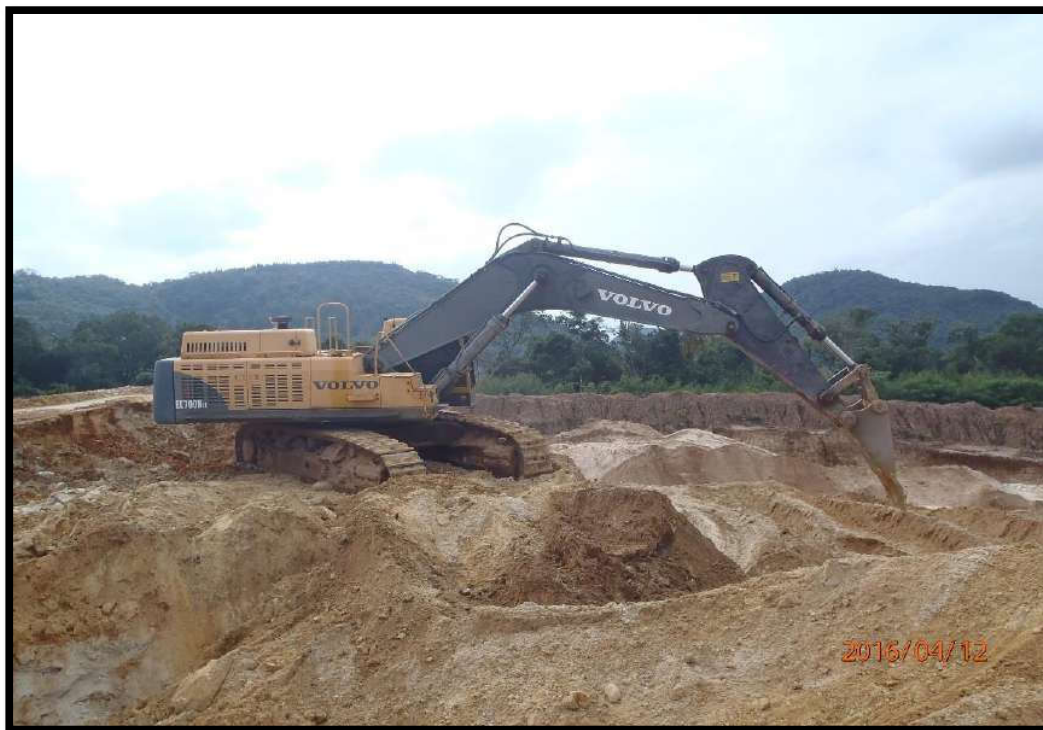
Figura 2- operação de desmonte do material utilizando-se escavadeira hidráulica na em frente de lavra na Jazida Seger. Fonte: Autor, 2016.
