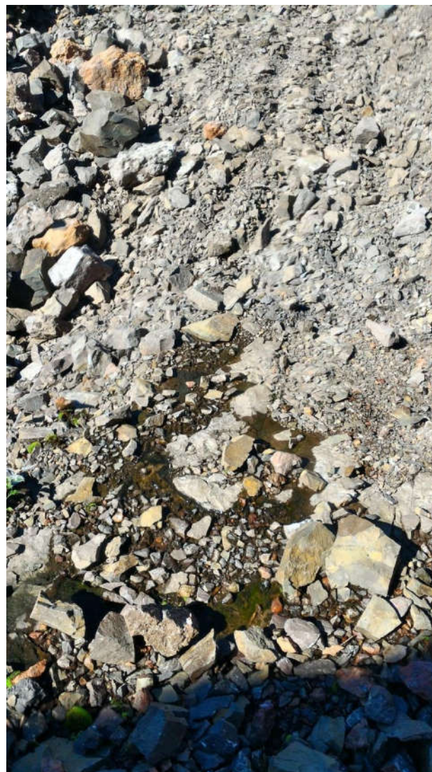
FIGURA 305a e 305b – Pontos onde foi observada a presença de água em algumas descontinuidades.
