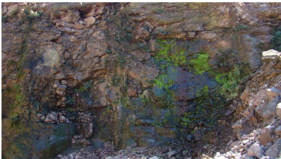
FIGURA 303a e 303b – Vista geral de afloramento e detalhe dos basaltos da Formação Serra Geral, evidenciando o fraturamento, o preenchimento e a direção das fraturas NW.
