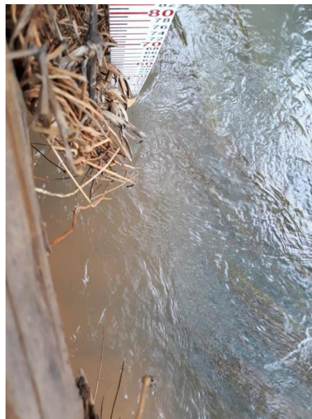
Figura 48: Determinação do nível para cálculo da vazão. Dia 28/01/2019.
