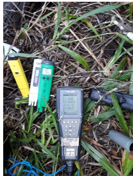
Figura 51: Equipamentos para medição de pH, Sólidos, Potencial de Oxirredução, Oxigênio Dissolvido e Temperatura, no ponto montante.
