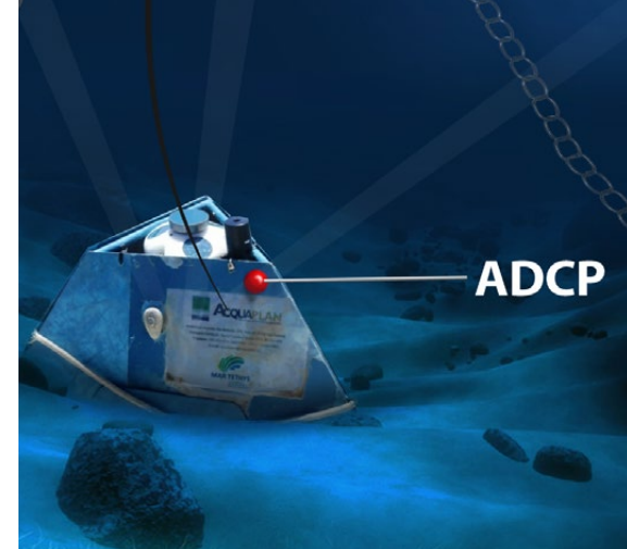
Figura 30. Equipamento ADCP modelo AWAC® utilizado no fundeio já fixado em estrutura piramidal.
