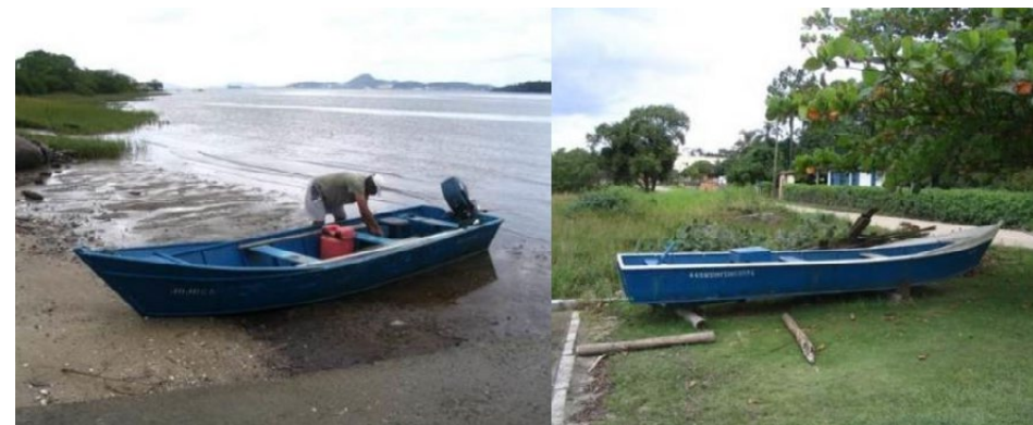
Figura 65. Bateira com motor de popa (à esquerda) e com motor de centro (à direita).
