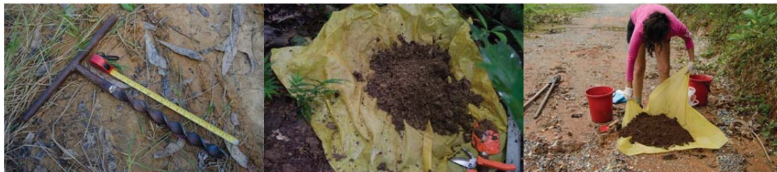
Figura 6-14: Método de coleta e preparação das amostras. Fonte: do autor.
