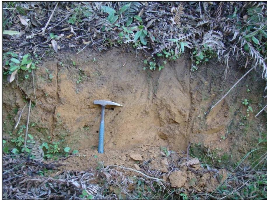
Figura 6-21 - Camada de solo orgânico seguida uma camada terrosa composta por silte e argila originada de granito.
