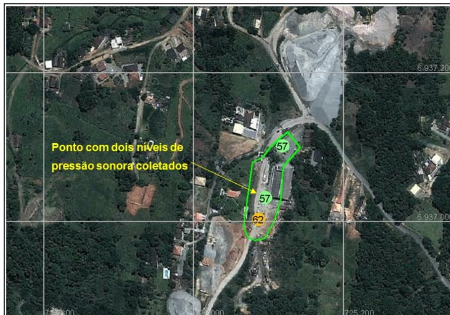
Figura 6-16 - Limite da área interna da empresa referente a balança, escritório e estacionamento e seus respectivos níveis de ruído.
