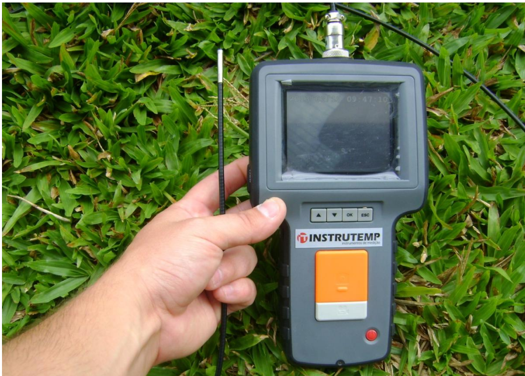
Figura 5.60 - Boroscópio e cabo de fibra ótica com micro câmera utilizado para visualização interna de tocas.
