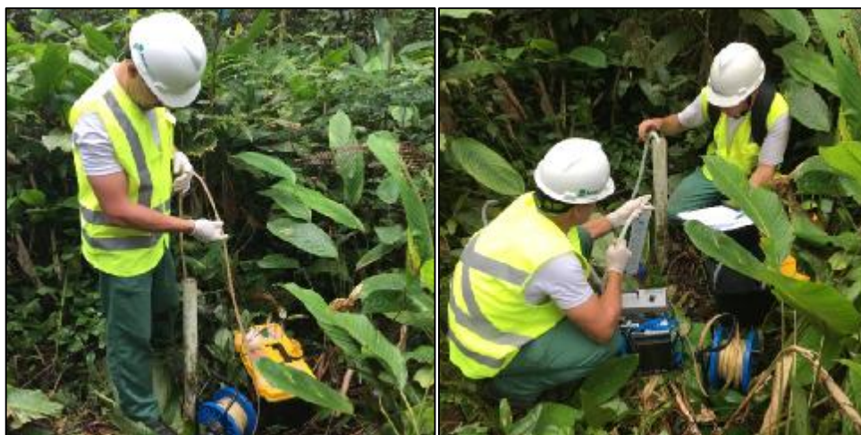
Figura 162. Mensuração do nível hidrostático com a utilização do medidor de nível HS. Fonte: ACQUAPLAN – 2017.
