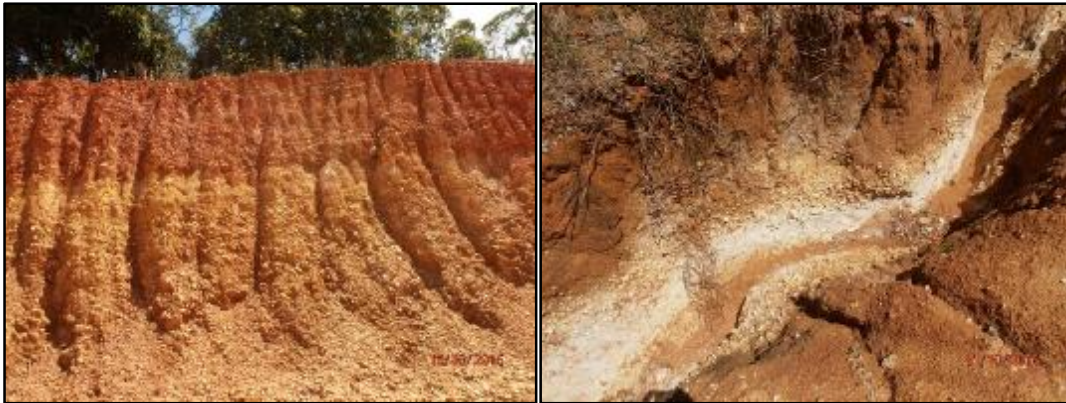
Figura 116. Aspecto dos colúvios encontrados na área. O aspecto comum é a repetição das cores de alteração da rocha. Em alguns locais o colúvio possui uma camada de argila branca associada a profundidade onde concentra-se maior quantidade de seixos de quartzo. Fonte: Diretrizes Ambiental – 2017.
