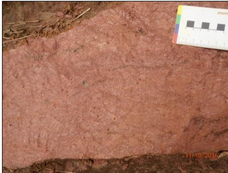
Figura 110. Cristais de granada completamente alterados formando pontos escuros no xisto. Fonte: Diretrizes Ambiental – 2017.
