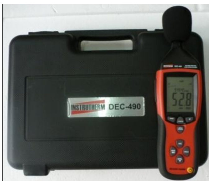
Figura 90. Medidor de nível de pressão sonora (decibelímetro) da marca Instrutherm, modelo DEC – 490 Digital. Fonte: ACQUAPLAN – 2017.
