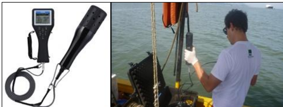
Figura 145. Sonda multiparâmetros Horiba U-50. Fonte:ACQUAPLAN - 2017
