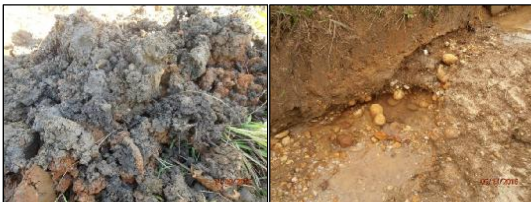
Figura 118. Aspecto dos sedimentos aluviais encontrados na área. Presença de argilas cinzentas, seixos de quartzo arredondados. Fonte: Diretrizes Ambiental – 2017.
