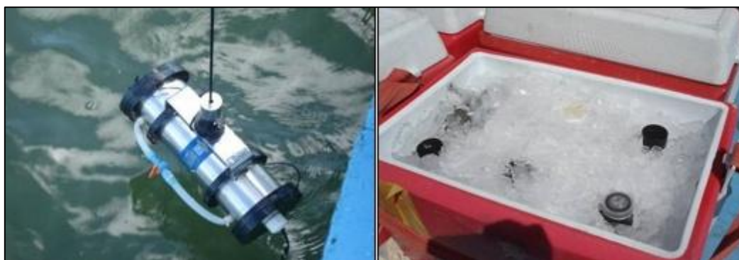
Figura 146. Garrafa amostradora do tipo van Dorn utilizada para coleta de água e caixa térmica utilizada para armazenamento das amostras de água. Fonte:ACQUAPLAN - 2017
