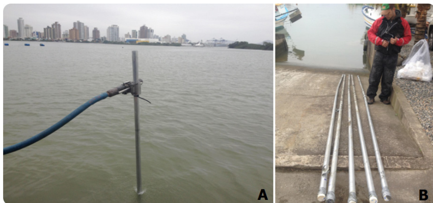
Figura 26. Método de coleta de sedimento utilizado no Saco da Fazenda: A) Testemunhagem com vibração do tipo Vibra Core; B) Tubos com amostras da coluna sedimentar.
