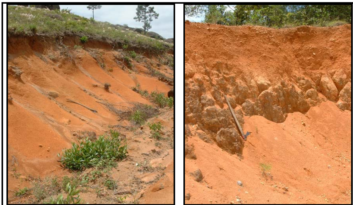
Figura 68. Locais de ocorrência de solos Podzólico Vermelho-Amarelo, encontrados nas partes mais elevadas da área do empreendimento, próximos aos solos do tipo Litólico e Cambissolos, porém, em declividades menos acentuadas
