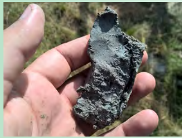
▲ Silte argiloso encontrado em profundidades abaixo de 7 metros.
