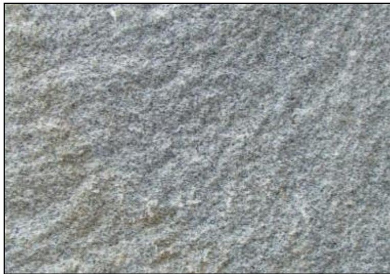
Figura 6-26 - Granito com granulação média, com cristais milimétricos, texturas fanerítica e equigranular, cor cinza-claro.
