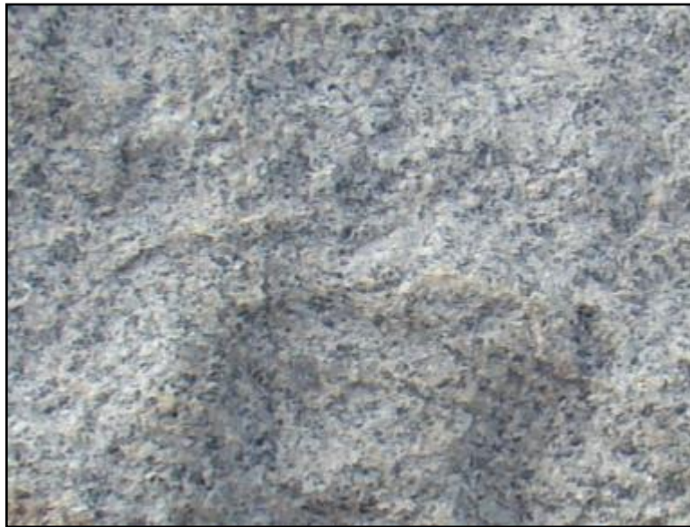
Figura 6-27 - Granito com granulação média a grossa, cristais centimétricos, texturas fanerítica e equigranular (tipo “sal e pimenta”), cor cinza, constituindo-se basicamente de plagioclásio, k-feldspato, quartzo e biotita.
