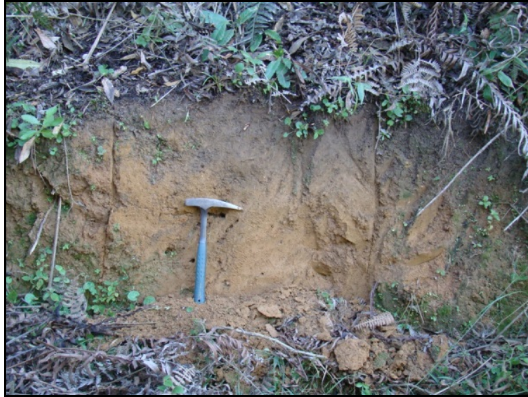
Figura 6-22 - Camada de solo orgânico seguida uma camada terrosa composta por silte e argila originada de granito.
