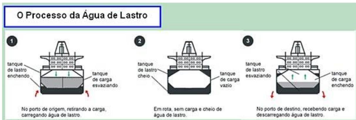
Figura 750. Procedimento de enchimento e esvaziamento da água de lastro. Fonte: Porto de Santos.
