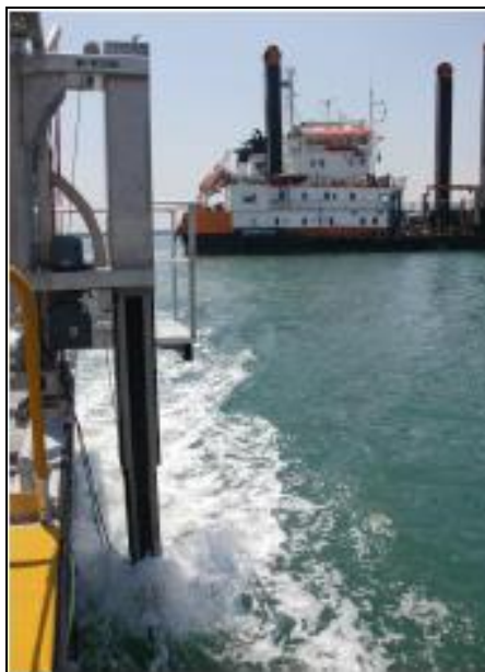
Figura 744. Equipamento instalado em embarcação com função de medir as partículas em suspensão na coluna d'água durante as atividades de dragagem. Fonte: Van Oord (2014).
