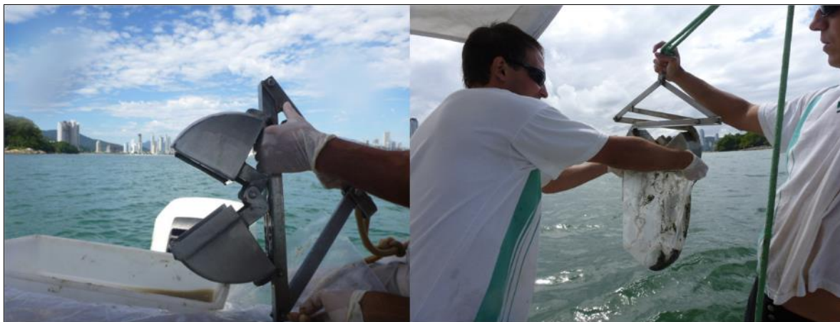
Figura 556. Busca fundo do tipo van Veen utilizado para a amostragem da macrofauna bentônica de fundo inconsolidado no infralitoral da enseada de Camboriú – SC, em 18 de fevereiro de 2016.
