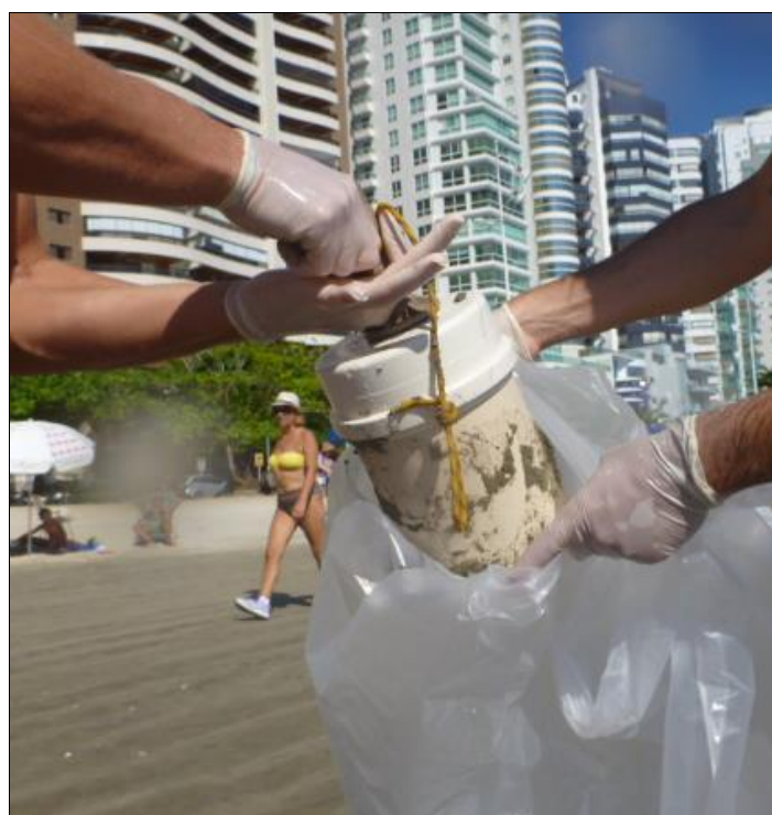
Figura 560. Amostrador de PVC utilizado para coleta da macrofauna bentônica de fundo inconsolidado da porção subaérea da Praia Central de Balneário Camboriú – SC, em 18 de fevereiro de 2016.
