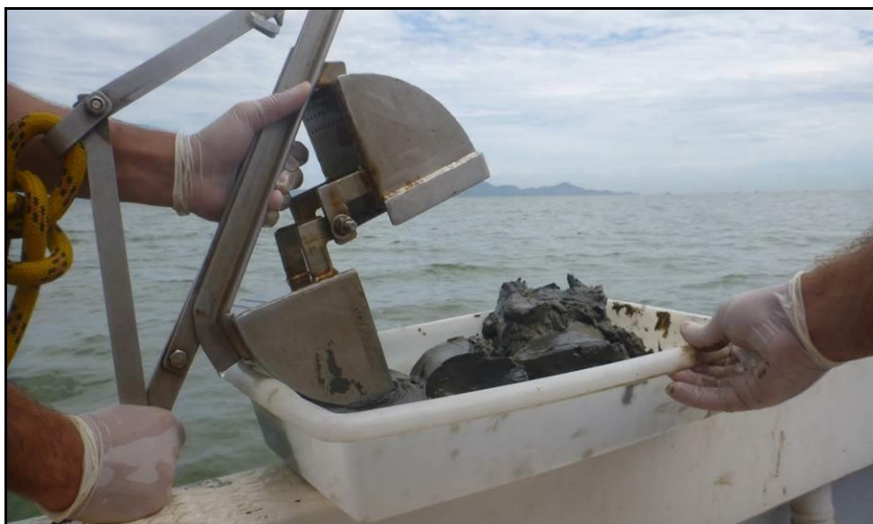
Figura 576. Draga busca-fundo do tipo van Veen utilizado para a coleta da macrofauna bentônica.
