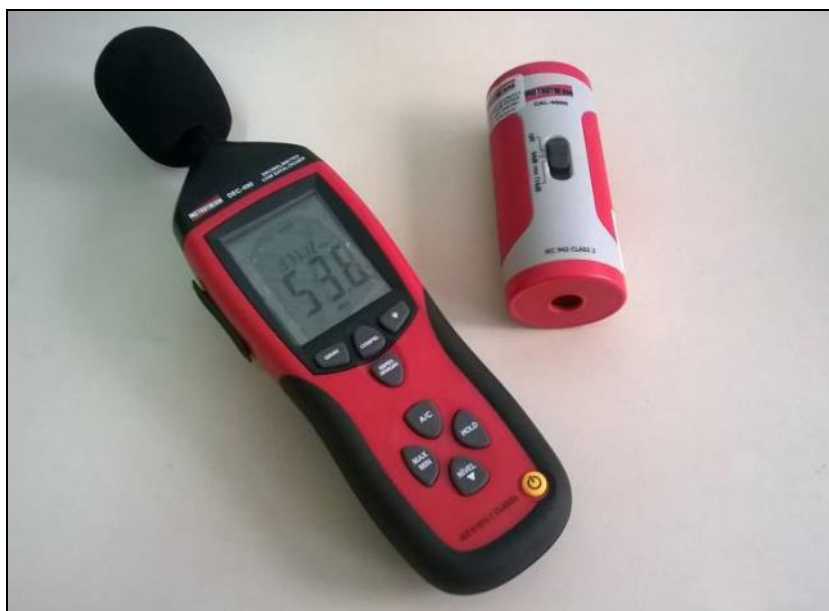
Figura 438. Medidor de nível de pressão sonora (decibelímetro) e calibrador de nível sonoro marca Instrutherm, modelo DEC-490 CAL – 4000.
