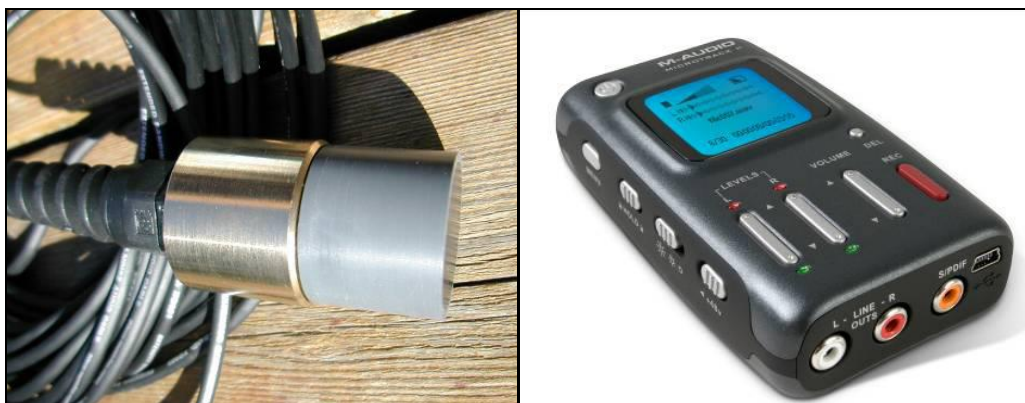
Figura 474. A esquerda o Hidrofone Cetacean Research SQ26-08 , e a direita o gravador digital M-Audio Microtrack II , utilizados para a coleta de dados de acústica.
