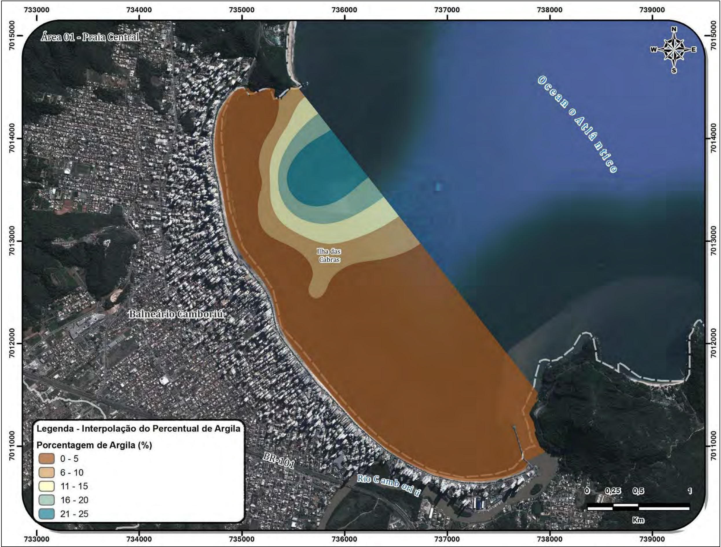
Figura 170. Concentração de argila nas amostras de sedimentos superficiais na enseada de Camboriú no ano de 2013.
