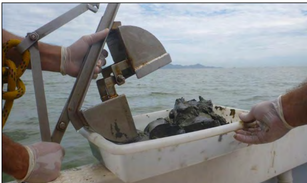
Figura 222. Amostrador do tipo van Veen utilizado para a coleta de amostras de sedimentos superficiais.
