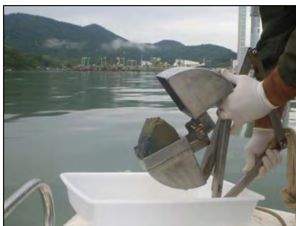
Figura 190. Draga busca-fundo do tipo van Veen .
