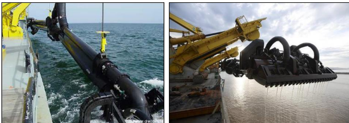
Figura 34. Articulação da tubulação e “boca” de draga hopper. Fonte: (E) dredgers.com e (D) jandenul.com.
