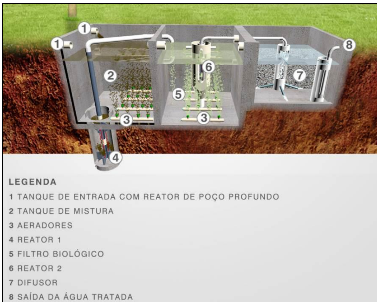
Figura 94. Diagrama básico de funcionamento do sistema coroh®.
