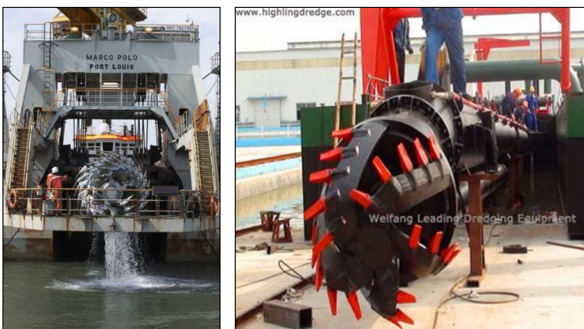
Figura 37. Detalhe da draga de sucção e recalque. Fontes: (E) Jandenul.com e (D) http://www.highlingdredge.com/product.asp?leibie=73 .
