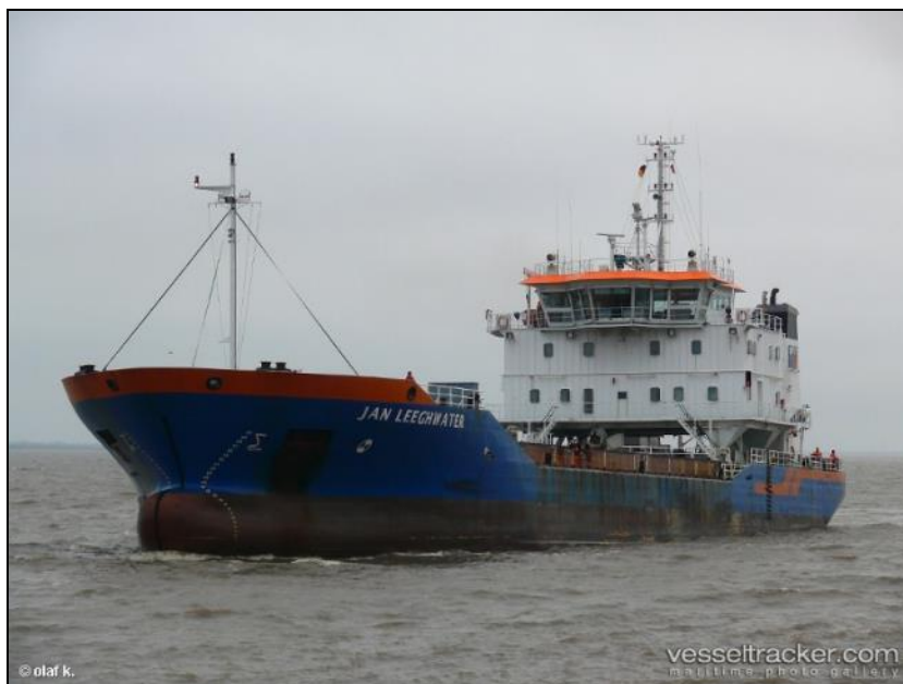
Figura 44. Exemplo de uma barcaça de transporte de material dragado, denominado "batelão". Fonte: vesseltracker.com
