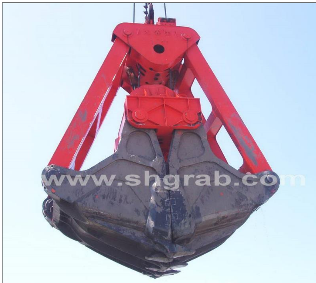
Figura 40. Detalhe do equipamento de mandíbulas de caçamba. Fonte: http://www.shgrab.com/Product/20100406173516453.html .
