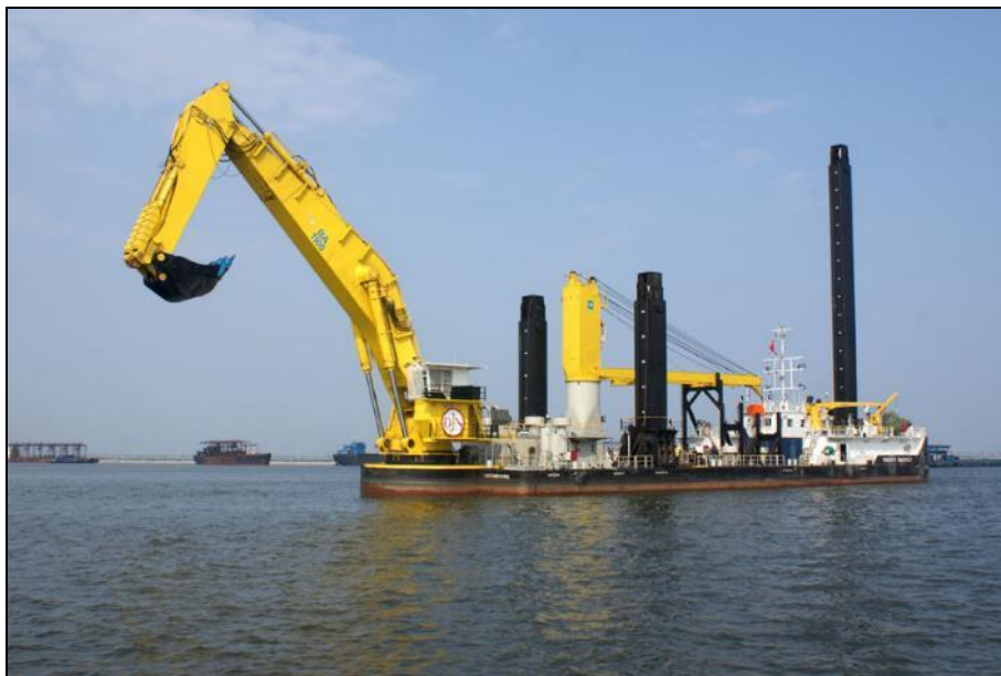
Figura 42. Dragagem escavadeira tipo backhoe . Detalhe dos três charutos montados na plataforma, dois deles fixados ao substrato para aumento do torque durante escavação. Fonte: jandenul.com.
