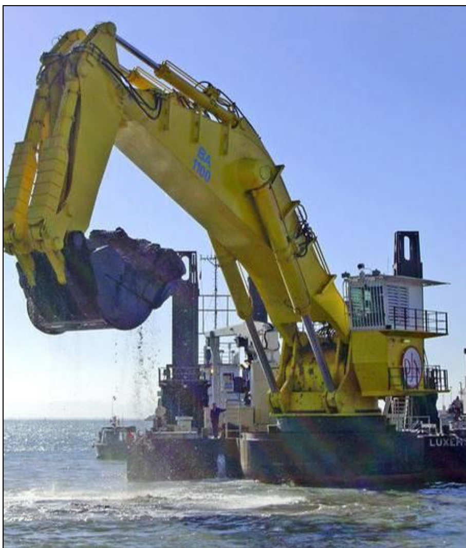
Figura 43. Dragagem escavadeira Vitruvius . Fonte: jandenul.com.
