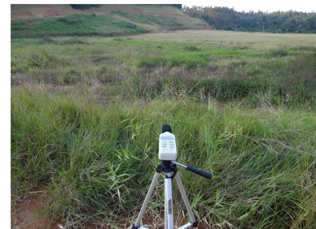
Medidor de Nível de Pressão Sonora (decibelímetro) utilizado no levantamento de dados de ruído na área de estudo.
