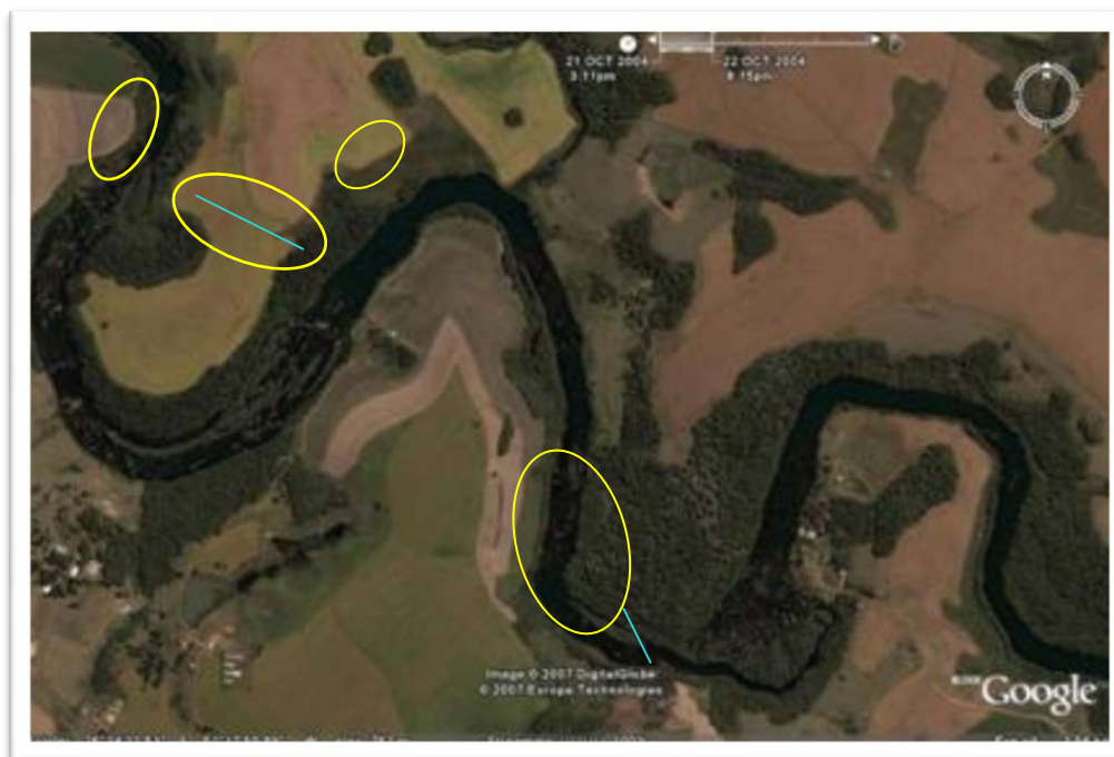
Figura 17 - Imagem aérea indicando os pontos: Linha a=barramento, linha b=final do lago; Ponto 1 = local do barramento, e canteiro de obras; Ponto 2= canal de adução; Ponto 3 = local de implantação da casa de força; Ponto 3 = ponto com maior concentração de vegetação, fragmento mais significativo.
