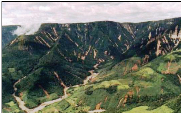
Figura 4.1-11: Movimentos de massas na encosta superior da escarpa, evoluindo para debris flow, onde o fluxo era canalizado. Local: vale do rio Figueira, município de Timbé do Sul
