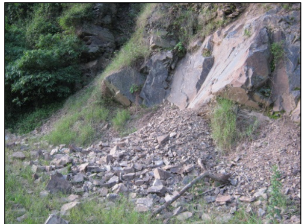
Figura 3.2-X: Detalhe do material rochoso do escorregamento ocorrido na BR 470 (siltito e riolito)
