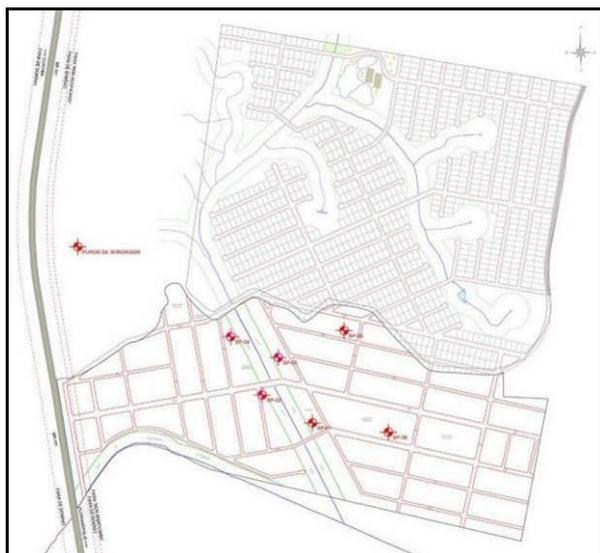
Esquema de localização dos seis furos de sondagem executados pela empresa FURO & SOLO Perfurações. Fonte: Elaboração própria.
