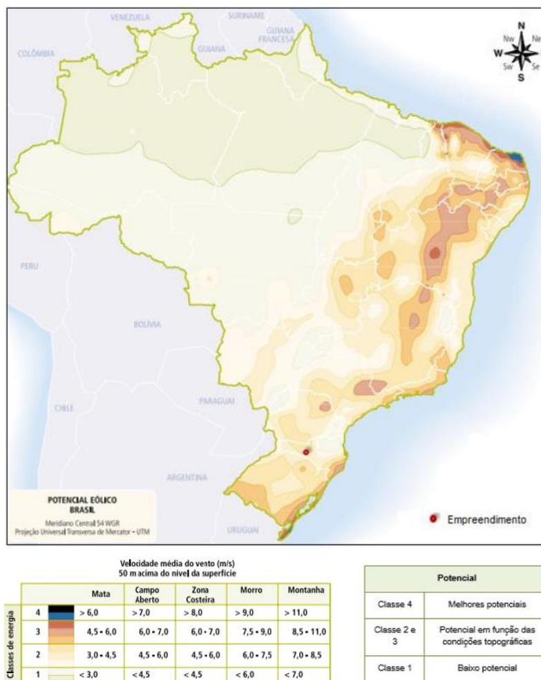
Figura 5.1 -Velocidade média anual do vento a 50m de altura. Fonte: Adaptado de ANEEL, 2005.
